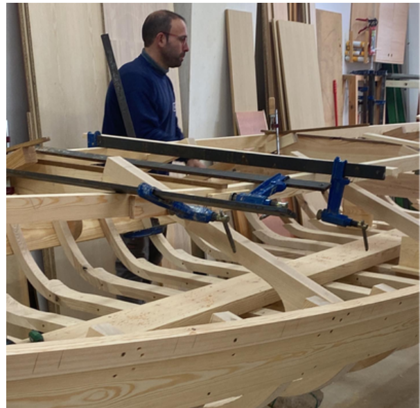
Juan Aleixandre, construyendo en su taller un barco de madera. ©Amparo Aleixandre.
